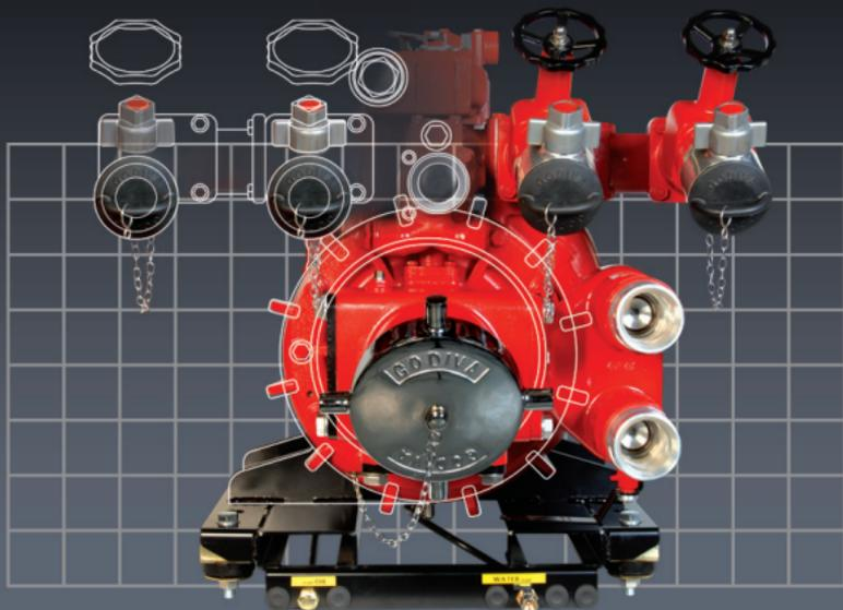
Godiva Feuerlöschkreiselpumpen der Prima Baureihe sind kompakt, leistungsstark und vielseitig. Sie stehen als ND und kombinierte ND – HD Ausführung, mit einer großen Auswahl an Nennleistungen, zur Verfügung. Der Einbau kann sowohl als Heckeinbaupumpe, als auch als „Midship-Pumpe“ erfolgen. Optional zur Ausführung in Aluminiumlegierung können die Pumpenteile aus Bronze gefertigt sein. Vorgefertigt auf einem Montagerahmen ist der Einbau mit minimalem Aufwand möglich.
