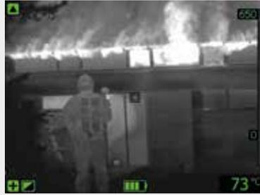
Identisch mit dem eingefärbten Brandbekämpfungsmodus, aber mit einem Graustufen-Bild.
