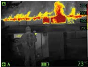
Für einen Einsatz in Verbindung mit höheren Hintergrundtemperaturen. Beispielsweise Gebäudebrände. Wo bereits zahlreiche offene Flammen und eine hohe Hintergrundtemperatur vorhanden sind.
