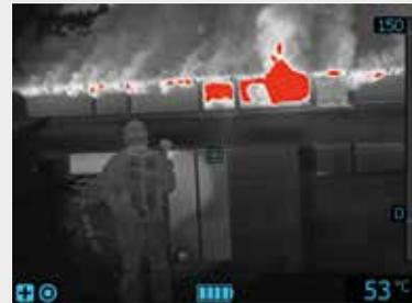
Für die Entdeckung heißer Stellen. Gegenstände mit einer Temperatur, die über einem vom Bediener eingestellten Wert liegt, erscheinen klar und deutlich auf dem Wärmebild.
